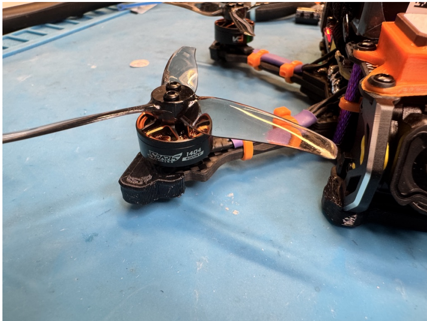
Actual motor close-up: 1404 4000KV.
